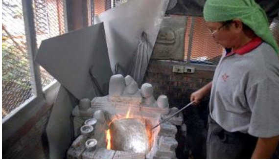
ภาพที่ ๘ นำเงินมาหลอมโดยใส่เข้าซึ่งทำด้วยดินเผามีลักษณะกลมแล้วนำไปเผาในเตาเผา
