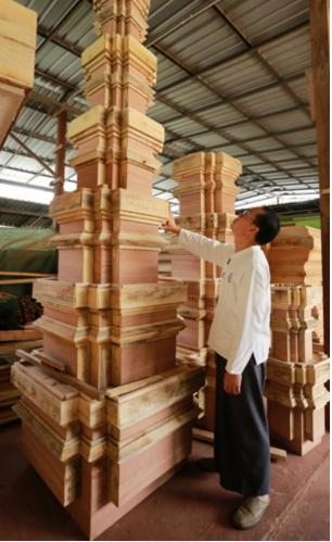
ขึ้นรูปซิ้นงานด้วยโครงสร้างไม้ที่เตรียมไว้ ซึ่งทรณีต้องมีการ วางปราสาทบนหลังนกหัสดีลิงค์ตามความเชื่อทางล้านนาก็จะต้อง มีการขึ้นโครงสร้างนกหัสดีลิงห์ด้วยไม้ไผ่ ไม้ไผ่สาน (สาดกะลา) น้า และกระดาษไว้ด้วย
